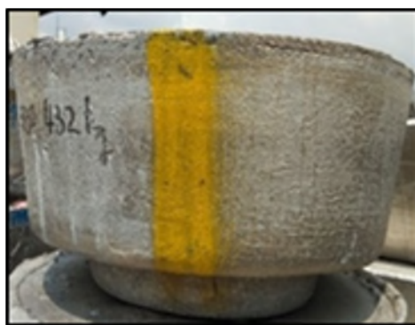
รูปที่ 2.3-1 ก้อนอลูมิเนียมที่ผ่านกระบวนการ Dross Recovery
